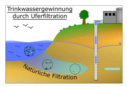
Oberflächenwasser strömt dem ufernahen Förderbrunnen zu. Durch die Untergrundpassage werden schädliche Mikroorganismen durch natürliche Prozesse aus dem Wasser gefiltert.
